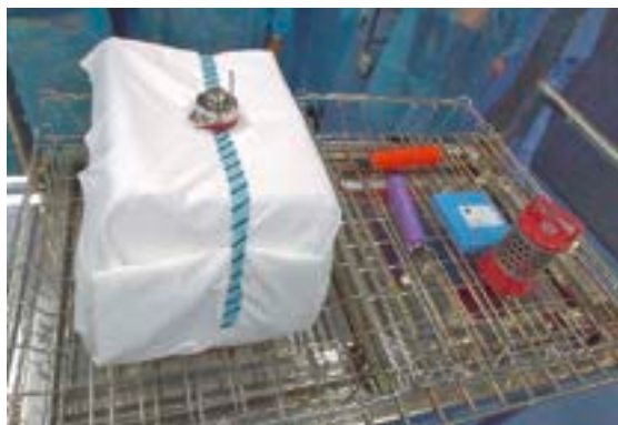
Abbildung 24 (unten rechts): Kuala Lumpur, Malaysia: Die Aufzeichnungen des Datenloggers zeigen den genauen Sterilisationsprozess. Dies kann während einer Schulung gezeigt werden, um zu erklären, was in einem Autoklav passiert.
