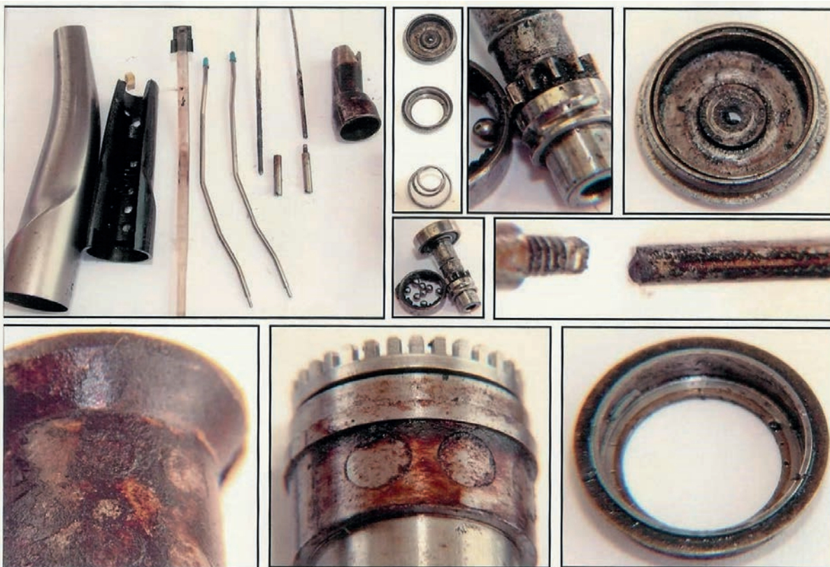
Abb. 7: Winkelstück zerlegt mit Anschmutzung durch nicht sachgemäße Aufbereitung.
