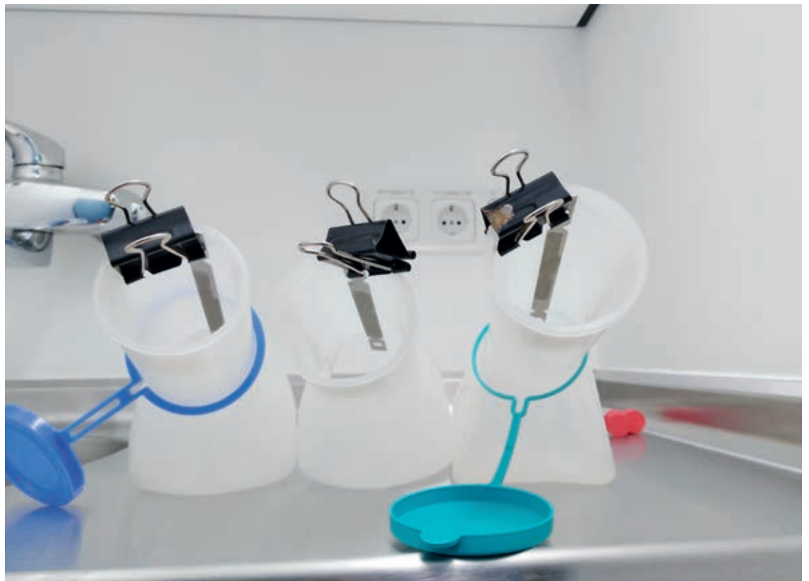
Abb. 6: Platzierung der Prüfkörper im Hals/Boden der Urinflasche (Quelle: Heike Kiesel B.A., kkm)
