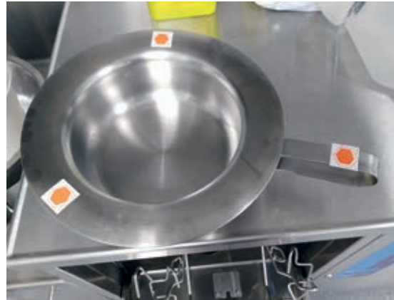
Abb. 3: Platzierung der Prüfkörper am Steckbecken (Quelle: Markus Kiesel MSc, kkm)
