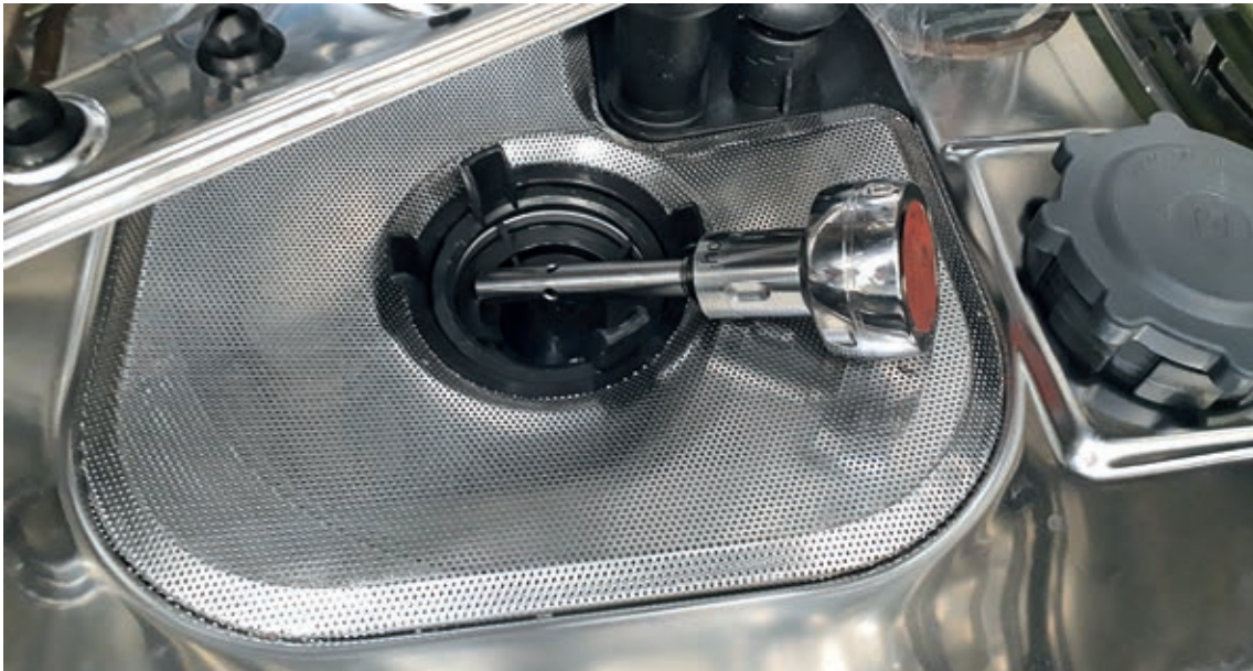
Abb. 2: Leitwertlogger im Ablauf des RDG zur permanenten Messung des Leitwertes und der Temperatur
