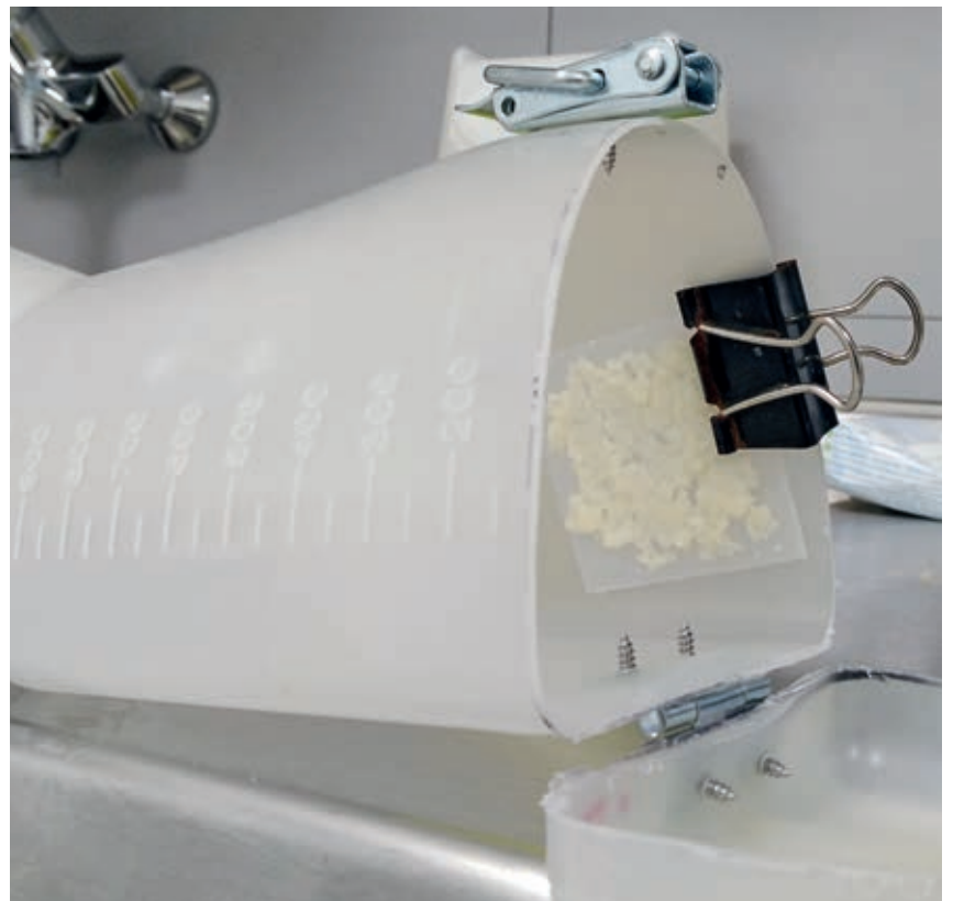
Abb. 5: Indikatoren mit Restanschmutzung nach Durchlauf (Quelle: Markus Kiesel MSc, kkm)
